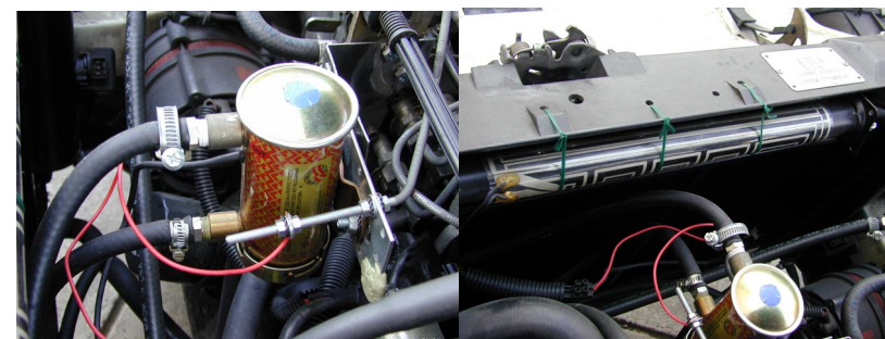
Pompe de pré-gavage FACET Réchauffeur électrique dit « Pétalette »
